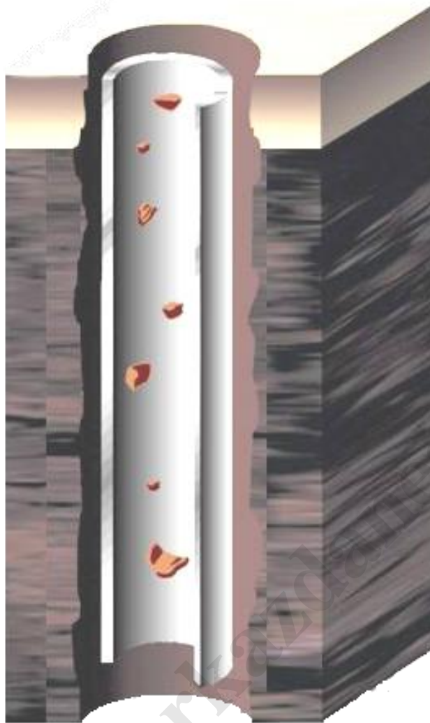
شکل 3- نمایی از انتقال کنده‌های حفاری به وسیله هوا.
